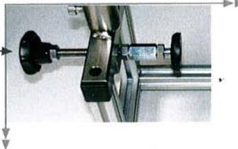
Pour faciliter la mise en place, la bonne distance du conditionneur peut-être déterminée à l'aide du bouton d'ajustement ...
